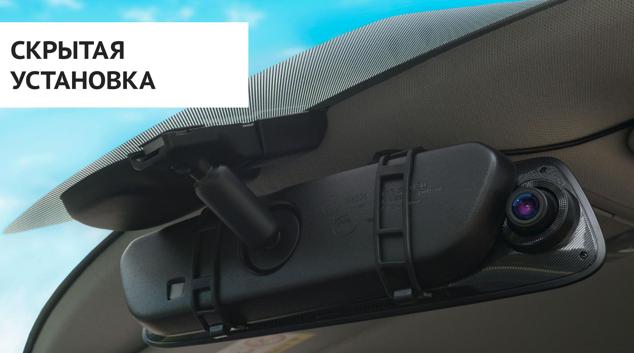
Видеорегистратор **iBOX Compass Dual** крепится поверх штатного зеркала заднего вида. Устройство не занимает дополнительную площадь на лобовом стекле и остается скрытым от излишнего внимания посторонних.
